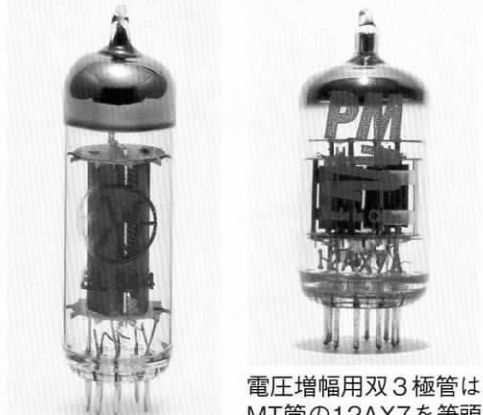
ヴォックスAC15、AC30など、ブリティッシュサウンドを支えてきたEL84のバリエーションである、JJエレクトロニクスのEL844。出力を低くして歪みやすくした新製品
