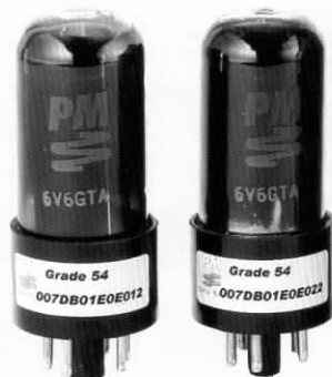
米国フェンダーのチャンプなど、小型アンプに多く使用された6V6GT
