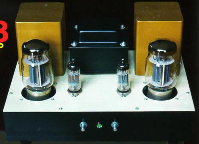
◆先月号で行った差し替え実験で二番大変なのが、個々のプレート電流が揃うまで繰り返しバイアス調整だ。本機ではバイアス自動調整回路を組み込み、球の差し替えやばらつきだけでなく、商用電源の電圧変動にも対応する。その効果は大きく、最大出力時のひずみ率が大幅に低減した。
